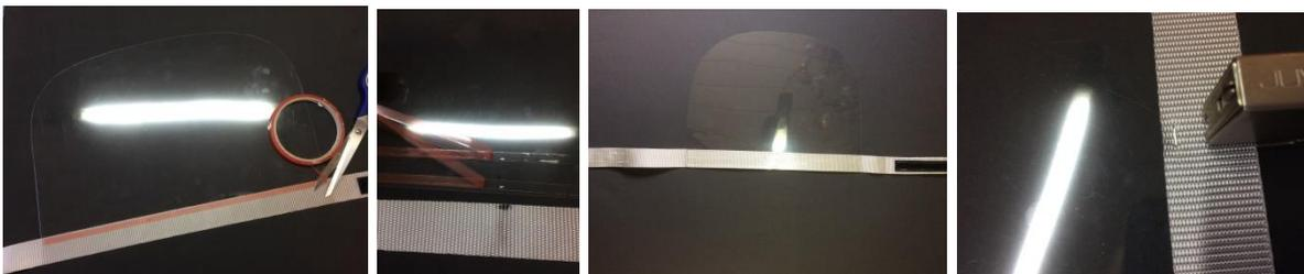
Doppelseitiges Klebeband auf den geraden Teil der Folie, in Breite des Gurtbandes festkleben und das Gurtband darauf mittig aufkleben.
